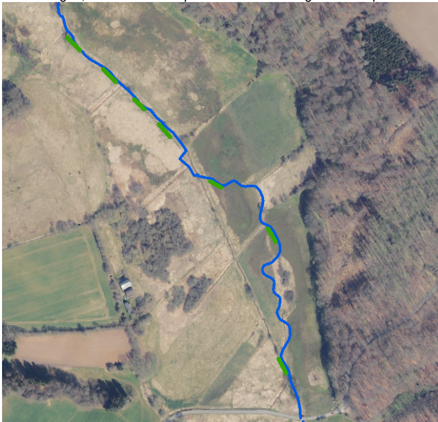
Figur 5: placering af træbeplantninger ved Skærup Å, samt udlægning af standsten
