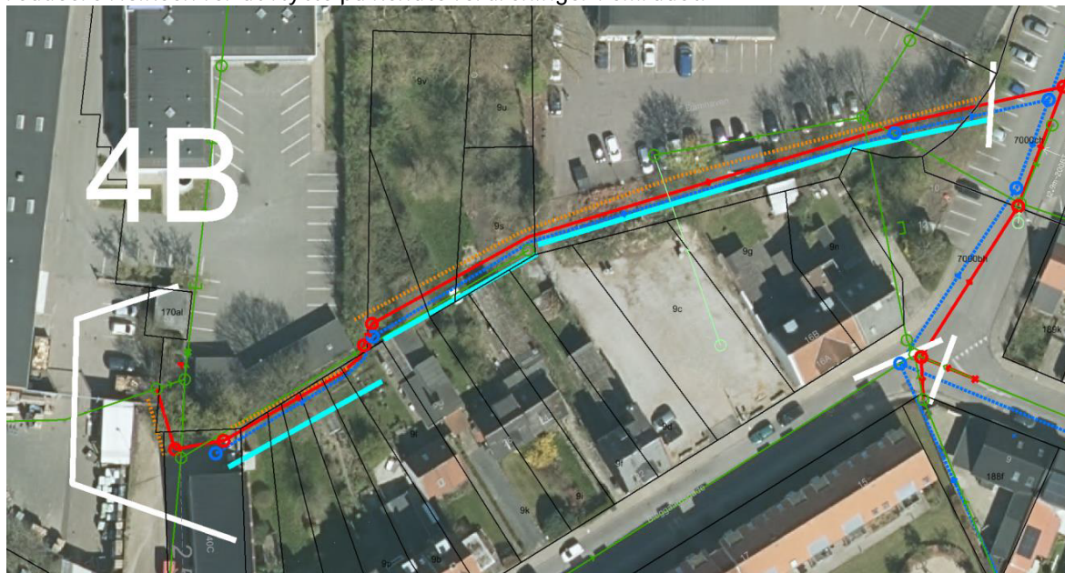
Figur 2. Nye kloakledninger er tegnet med rød og blå. Forventet placering af sugespidses og reinjektionsspidses er markeret med orange og cyan.
