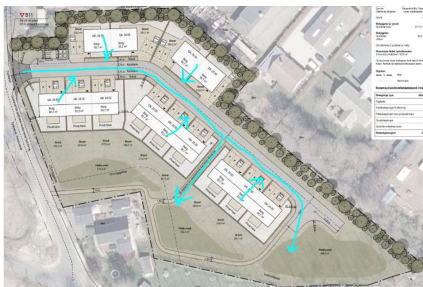
Billede 4 viser kort med strømningsveje for regnvandshåndtering på terræn.
